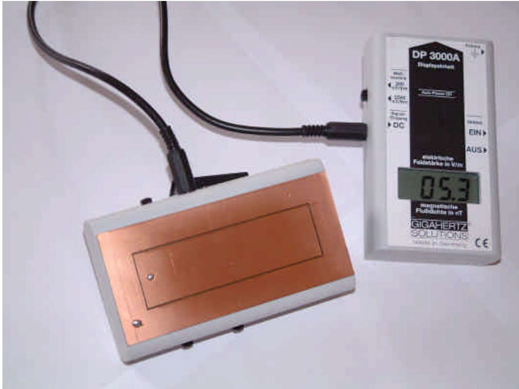
Abbildung 4.2-8 TCO-Sonde Gigahertz Solutions ME 3951 A „modifiziert“ (Vorderansicht), mit flachem Sensor, Geometrie gegenüber TCO-Spezifikation verkleinert und rechteckig; zusätzliche Anzeigeeinheit DP 3000A
