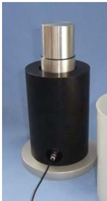
DETEKTOR BASIS FÜR G-EXPLORER Zur Aufnahme eines 2 x 2“ NaJ-Detektors für die Messung mit Marinelli Messbecher Artikel-Nr.: 1023
