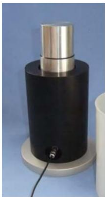
BASE DE DETECTOR PARA G-EXPLORER Para montar un detector NaJ de 2 x 2" Para medir con taza medidora Marinelli Artículo n.º: 1023
