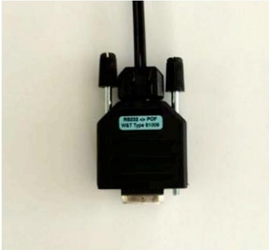
Convertidor de interfaz de fibra óptica RS232 convertidor óptico-RS232
